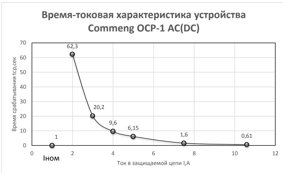
Рисунок А.3. Время-токовая характеристика устройства **Commeng OCP-1 AC(DC)**
